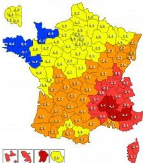
**Figure 38 – Densité de foudroiement sur le territoire métropolitain (source : [www.paratonnerres-radioactifs.fr](http://www.paratonnerres-radioactifs.fr))**
